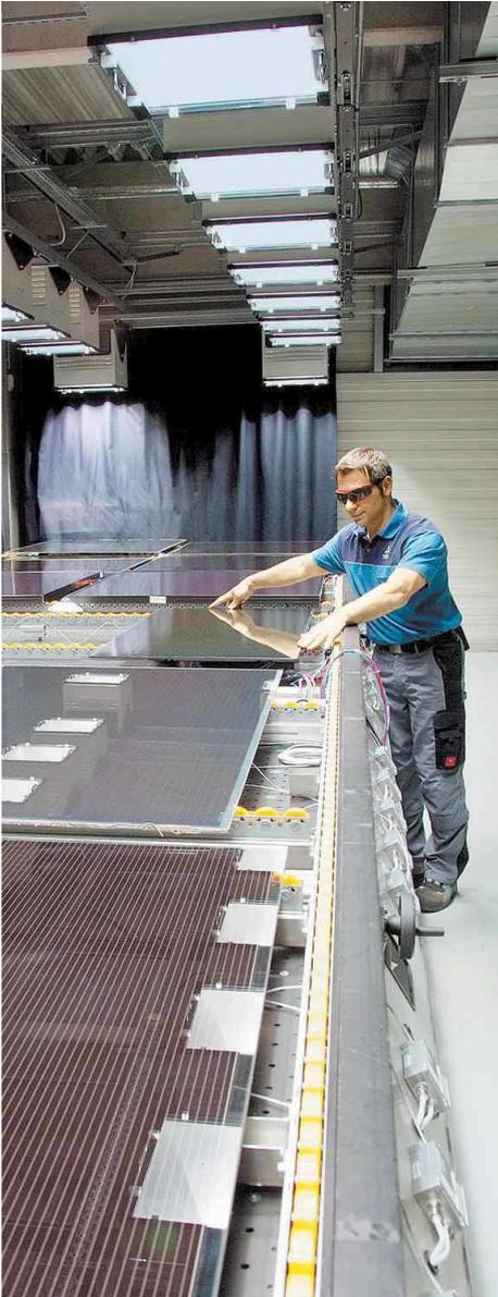
Ein Ingenieur kontrolliert im Solarprüfzentrum des TÜV Rheinland in Köln den Prozess der Voralterung von Dünnschichtmodulen: Diese werden 48 Stunden lang mit Tageslicht beleuchtet, um sie unter Belastung zu testen
