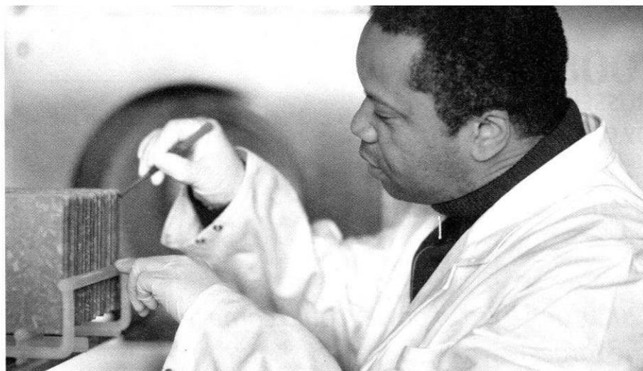
**Neue Wafer:** Berlin Solar arbeitet mit Siliziumscheiben aus direkt gereinigtem metallurgischem Silizium, einem neuen Zellengrundstoff.
