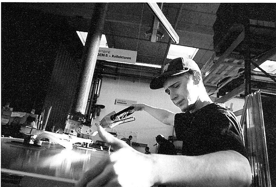
HEIKLES MANÖVER: Bei der Versiegelung des Kollektors mit der Glasplatte ist Vorsicht geboten.
