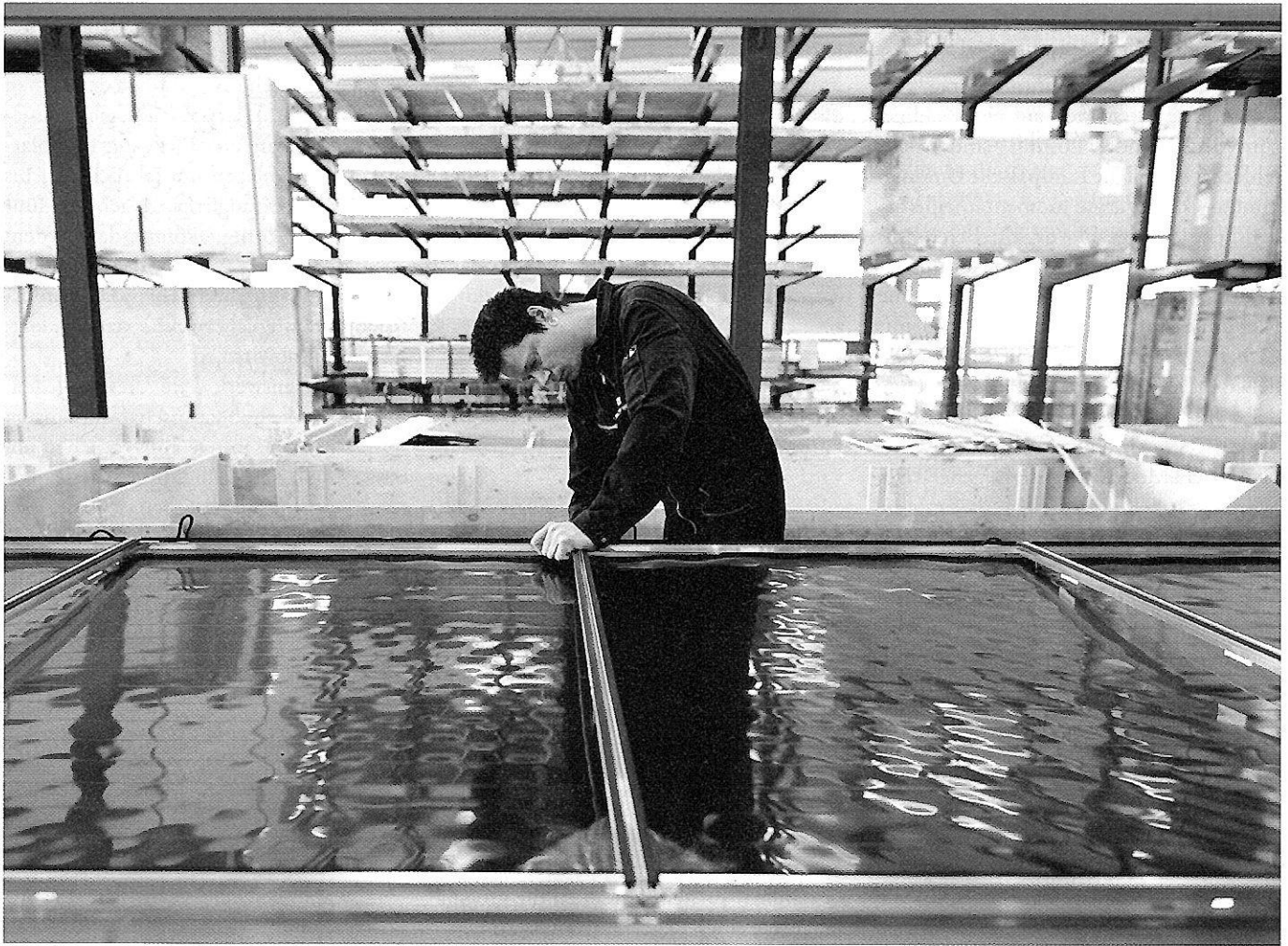
SCHWARZER RÜCKEN: Ein Stützrahmen mit Folie bildet die Kollektor-Rückseite
