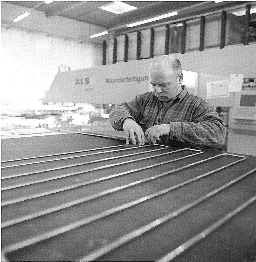
ROHRPRÄPARATION: Durch dünne Kupferröhren fließt das durch die Sonne erhitzte Solarfluid. Ein Mitarbeiter schaut nach den Verlötnungen.
