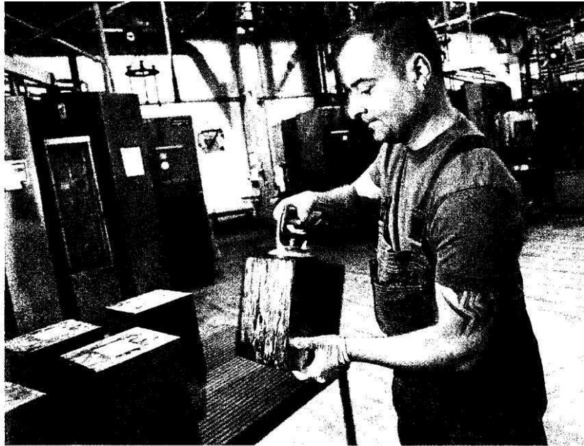
Grauer Block: In der Erfurter Fertigung von PV Crystalox wandert das zu Blöcken gesägte Material weiter in die Waferfertigung.
