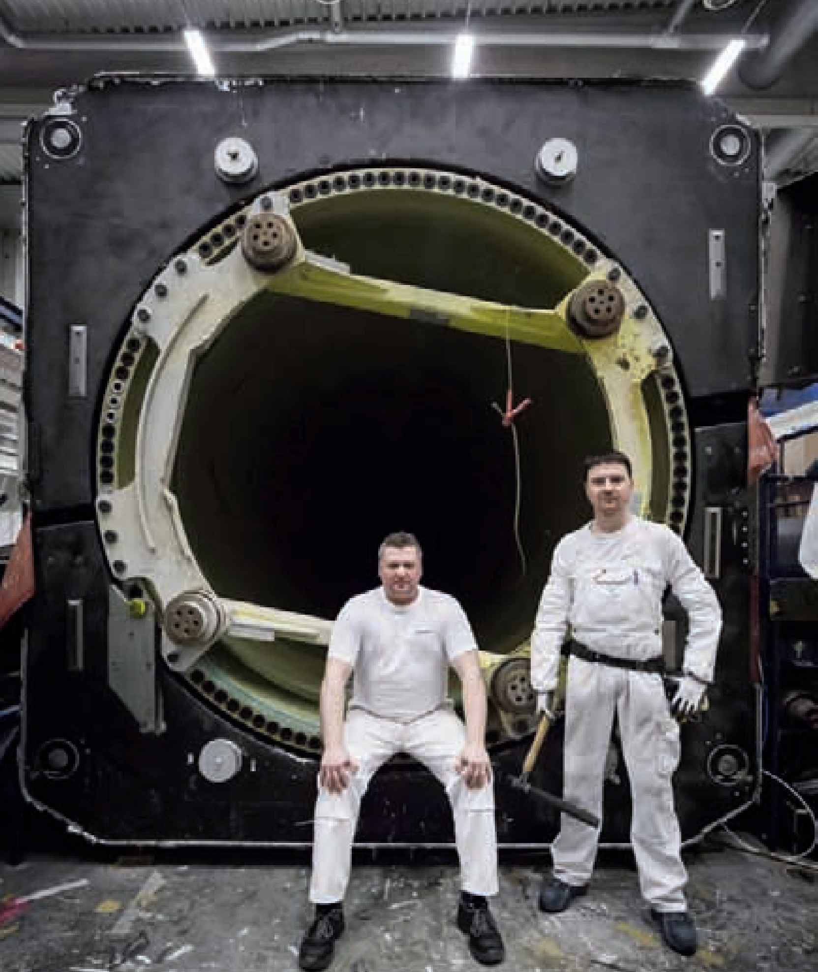
Fertiges Rohbauteil, noch in der Form: Mike Heintke und Sven Kullrich vor der Blattwurzel.
