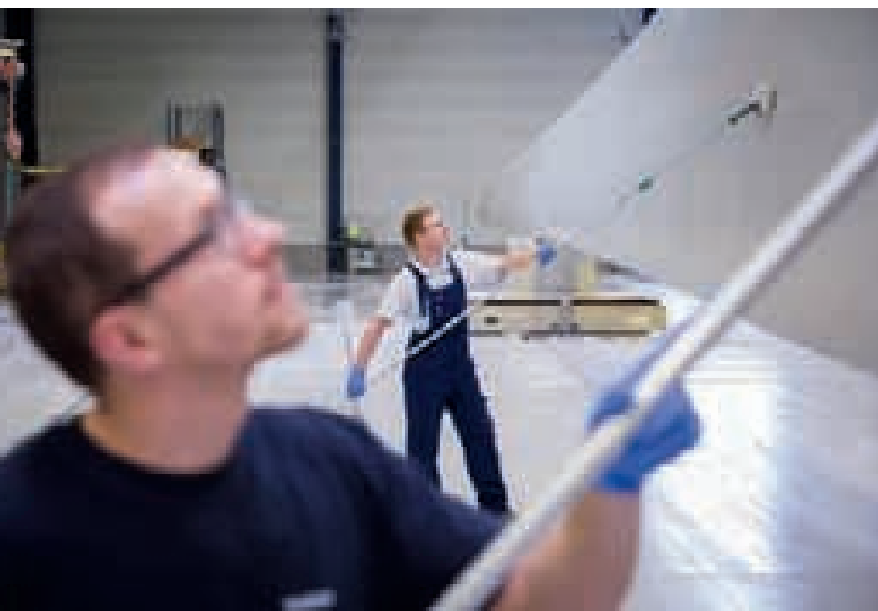
Entstauben: Martin Buder (l.) und Kai Hoffmann bereiten einen Flügel zum Lackieren vor.
