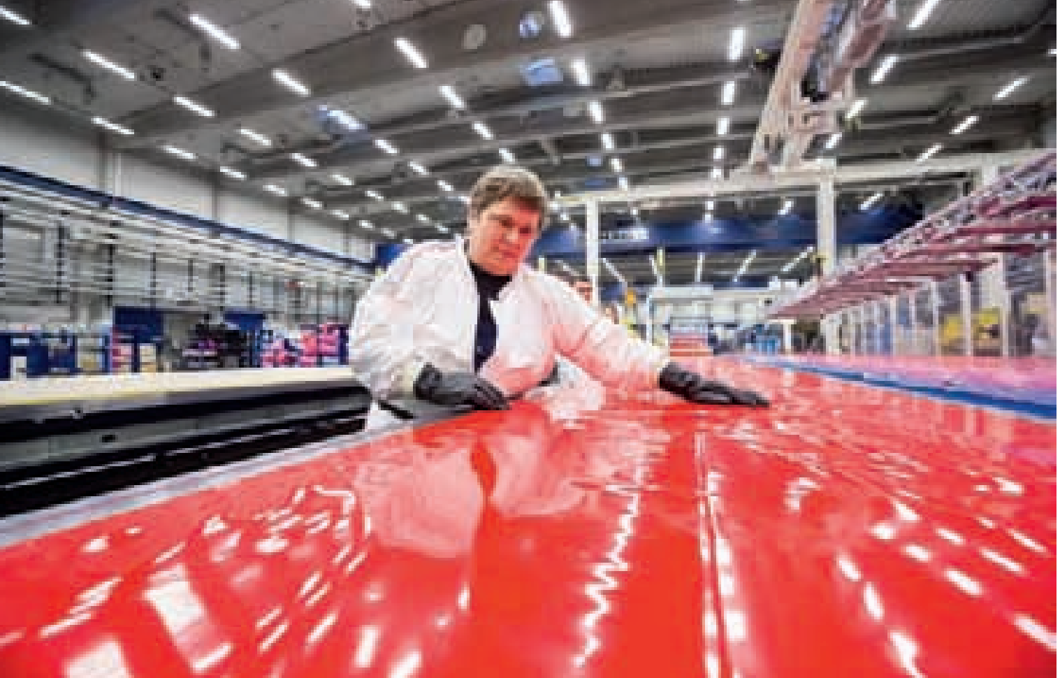
Nicht nur ein Männerjob: Jutta Roga beim Bau von Flanken für die Flügelhülle.
