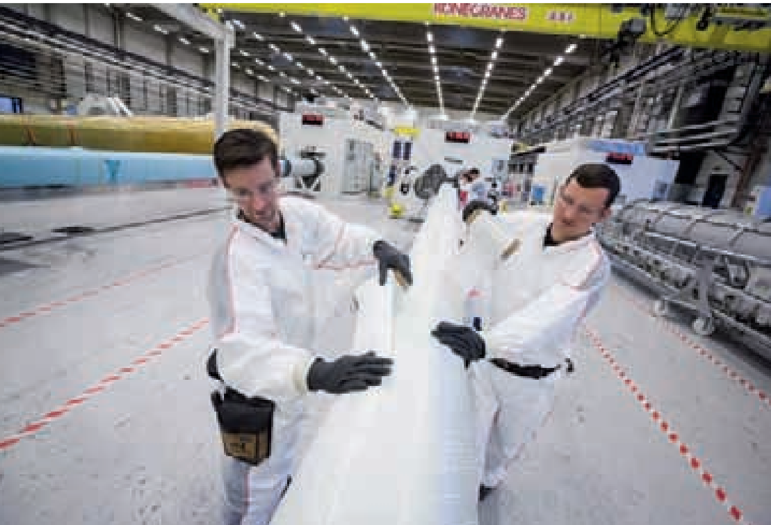
Herzstück: Christian Schwengberg (l.) und Andre Biele beim Bau des Midroot, einem Teilstück des Trägersegments.
