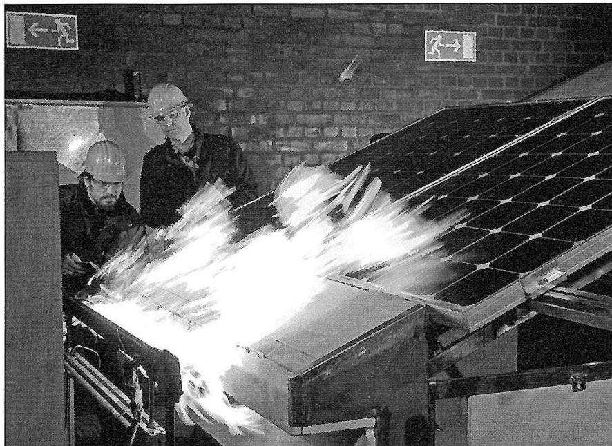
Härtestest: Brandschäden treiben die Kosten der Photovoltaikversicherer in die Höhe. Vor der Installation wird daher die Feuerfestigkeit der Solarmodule überprüft. TÜV Rheinland
