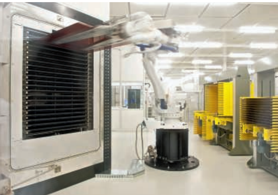
Rein in den Reaktor: Für einen zweistelligen Wirkungsgrad reicht eine amorphe Siliziumschicht nicht aus. In Berlin Marzahn erhalten die Dünnschichtpaneele daher in einem zweiten Reaktionsprozess noch eine mikrokristalline Schicht.
