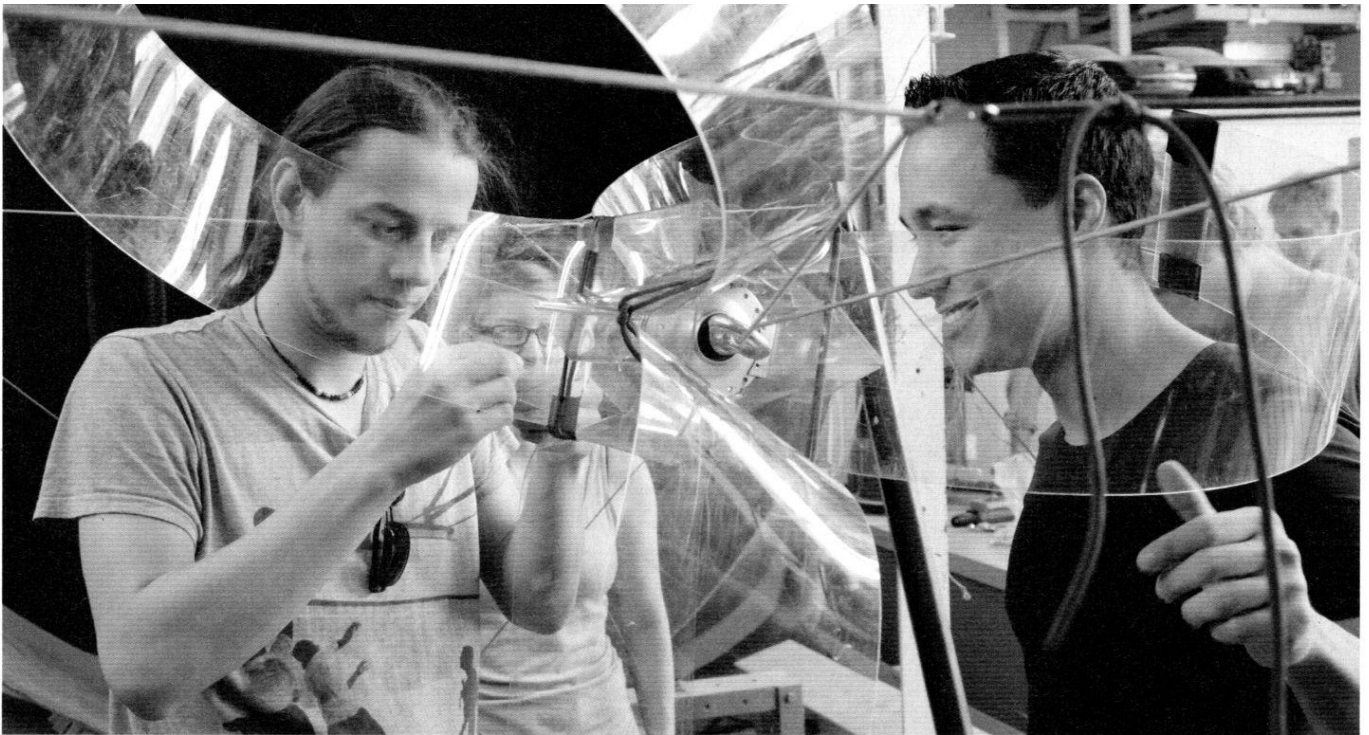
Mehrzweckhülle: Das „EnergyPack“ besteht aus einer dreieckigen Kunststoffverpackung, die Seile und einen Stromgenerator enthält. Um daraus ein Windrad zu bauen, werden die drei Seitenteile der Verpackung auseinander gerissen und zu kreisförmigen Flügeln zusammengesteckt.
