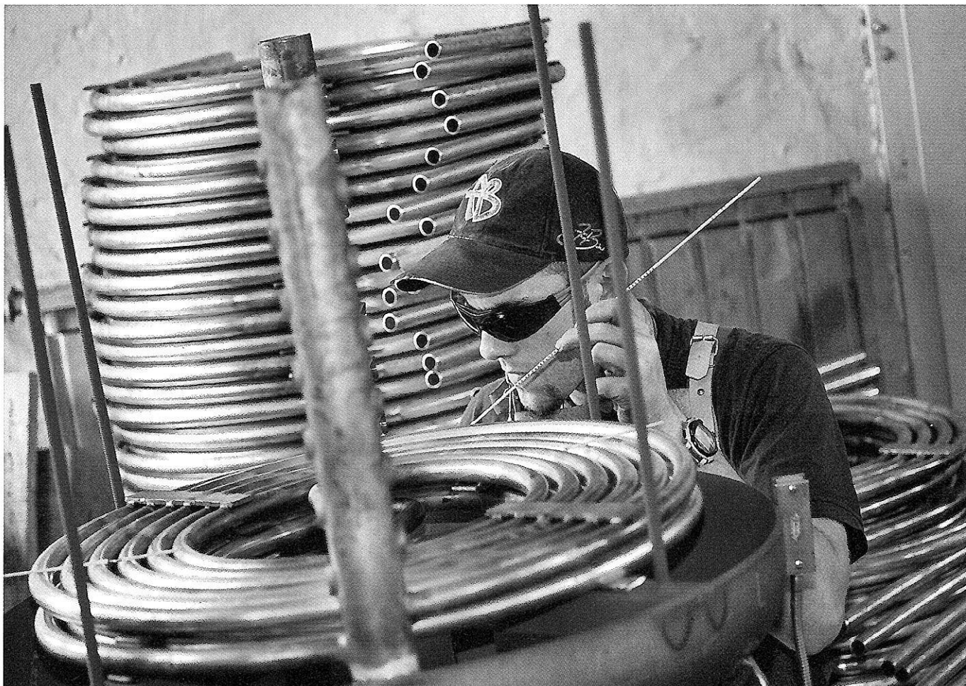
Präzisionsarbeit: Bei EAW, Anbieter von Absorptionskältemaschinen, verlötet ein Arbeiter Kupferrohre. Über sie wird Warmwasser aus Solarkollektoren zugeführt.
