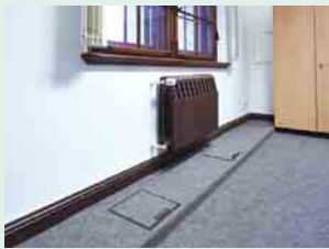
② Praxisbeispiel des Aufbodenkanalsystems
