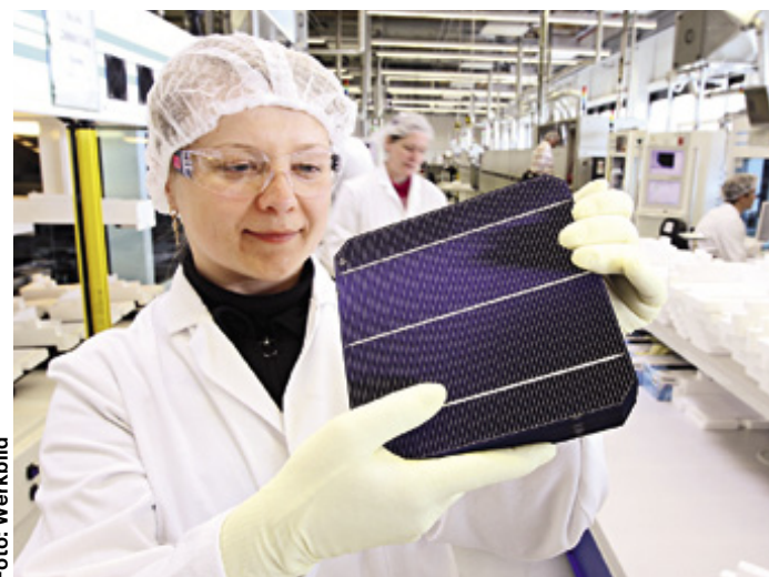
Klassische Siliziumzelle: Sie hat einen deutlich höheren Wirkungsgrad als ihre Konkurrenten aus der Dünnschichtfraktion.
