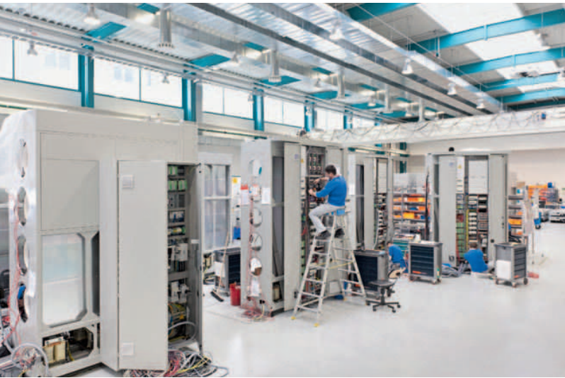
Phosphordiffusionsöfen: Wenn diese Anlage arbeitet, wird es drinnen 400 bis 1100 Grad Celcius heiß.
