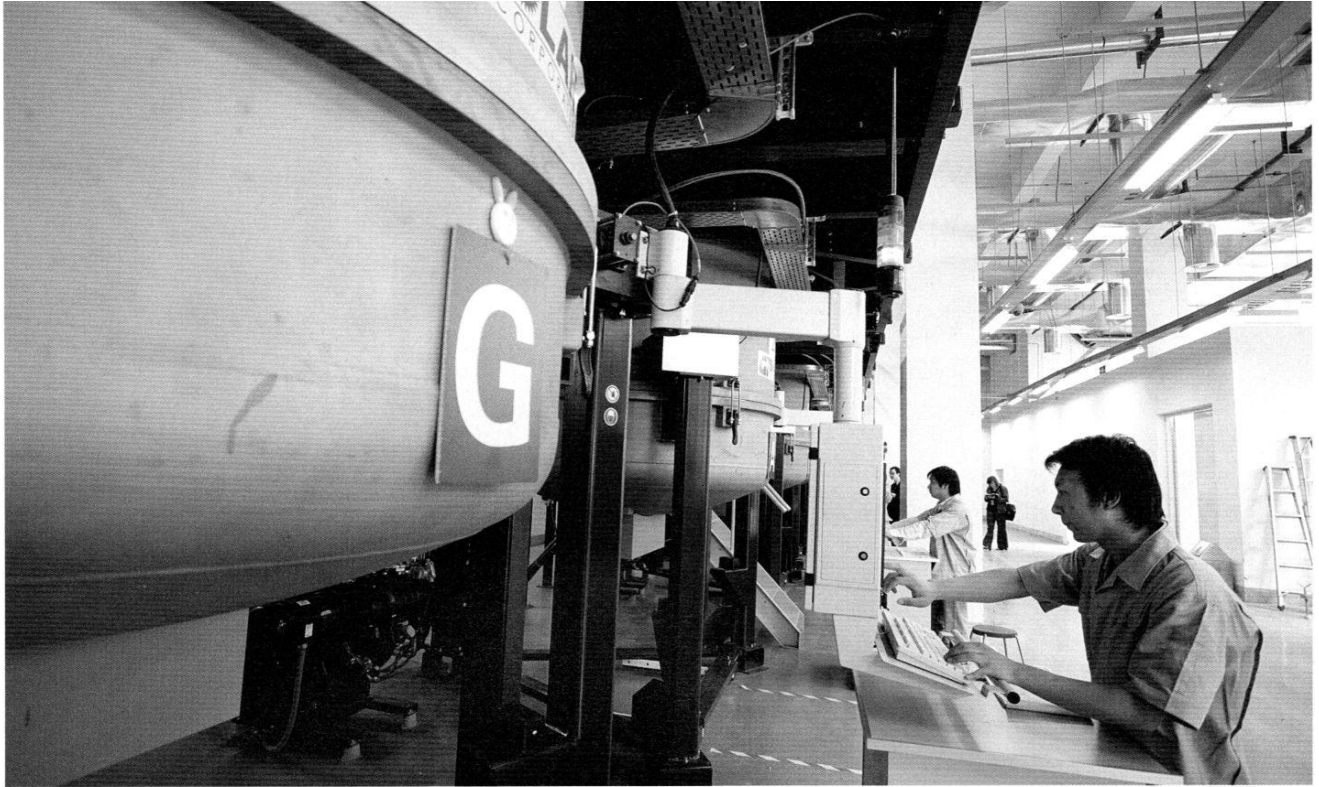
Mischgebäck: Multikristalline Siliziumblöcke werden in großen Tiegeln gegossen. Der chinesische Hersteller Ja-Solar fügt Einkristalle hinzu und produziert daraus mono-multikristalline Zwitterzellen (siehe Freisteller links).
