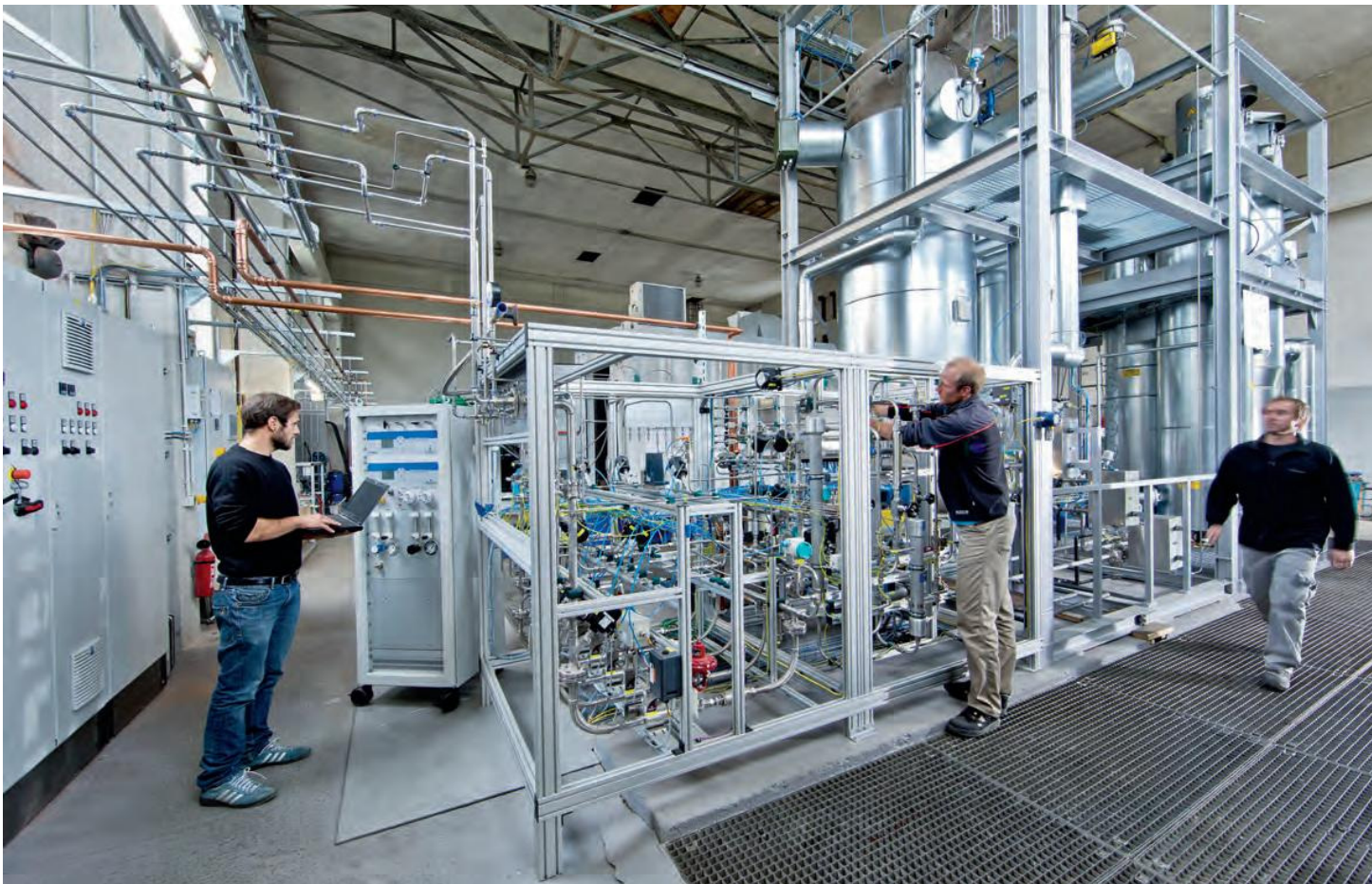
Strom zu Gas: Audi geht unter die Kraftstoffproduzenten. Mit der Power-to-Gas-Anlage wollen die Ingolstädter genug Windstrom in Methan umwandeln, um damit ihre gesamte Gasfahrzeugflotte zu betreiben.
