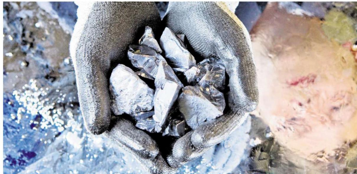
Gereinigtes Silizium im Entwicklungszentrum von Solarworld: Der Preis für das beim Bau von Solarzellen benötigte Halbmetall ist zuletzt massiv eingebrochen.
