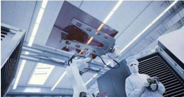
Sensibles Gut: Nach der Halbleiterbeschichtung werden Dünnschichtmodule behutsam zwischengelagert.
