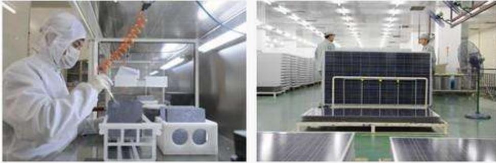
Links: Halbleitercheck: Ein Mitarbeiter des chinesischen Herstellers Suntech Power präpariert die Solar-Wafer zur Zellenproduktion. Rechts: Bereit für den Markt: Nach der Produktion werden die kristallinen Siliziummodule von Suntech ins Lager gebracht. Fotos: Suntech Power
