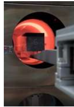
Energieintensiv: Zur elektr. Ausrichtung des Wafers bringen die Hersteller in Diffusionsöfen bei hohen Temperaturen Phosphor in das Silizium ein. Bild: Q-Cells
