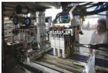
Nichts für Menschenhand: Das Verlöten der einzelnen Solarzellen zu Strängen ist ein heißes Thema: Viele Lote enthalten giftiges Blei. Bild: Aleo Solar
