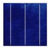
Q-Cells erkärt, durch die neue Rückseitenstruktur steige der Zellenwirkungsgrad in der Pilotproduktion auf 19,5 Prozent, bezogen auf das Modul auf 18 Prozent. 2012 soll die Technik unter dem Namen Quantum auf den Markt kommen. Bild: Q-Cells
