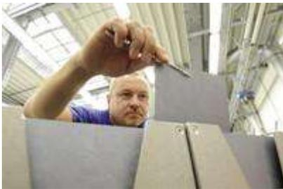
Zellenrohlinge: Erst mit der sogenannten Texturierung erhalten die Siliziumscheiben, die sogenannten Wafer, ihre typische blaue Farbe. Bild: Solarworld
