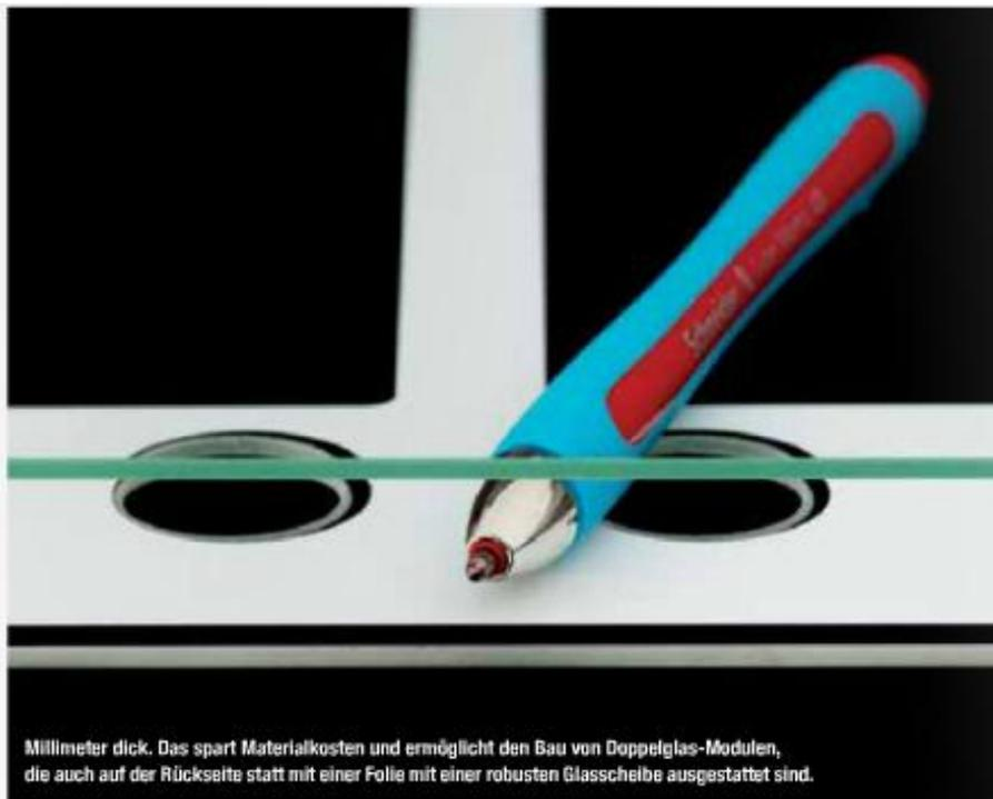
Millimeter dick. Das spart Materialkosten und ermöglicht den Bau von Doppelglas-Modulen, die auch auf der Rückseite statt mit einer Folie mit einer robusten Glasscheibe ausgestattet sind.
