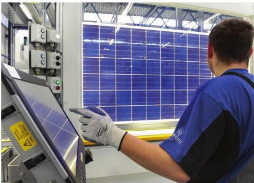
Schlüsselkomponente: Solarglas schützt die blau schimmernden Solarzellen nicht nur vor schädlichen Einflüssen, es hilft auch, möglichst viel Sonnenlicht einzufangen.
