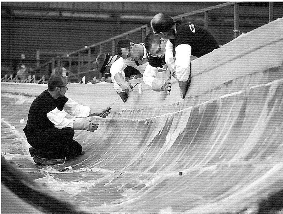
Handarbeit: Jedes Rotorblatt ist ein Unikat. Schon bei der Herstellung – hier eine Fertigungsanlage von Nordex in Rostock – können massenbedingte Unwuchten auftreten.
