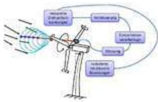
Ein System auf der Gondel wertet die Messdaten des Lidar-Geräts aus und schickt Signale an die Blattverstellung. Bei einer ankommenden Böe dreht sie Flügel vorzeitig aus dem Wind. ©Grafik: IFB, Universität Stuttgart
