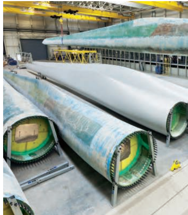
Rotorblätter in der Produktion
